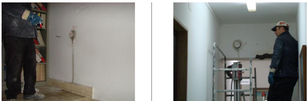
Figura 4 – Prelievo carote di cls
